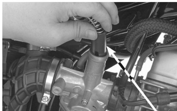
VÁLVULA DE ACELERAÇÃO VÁLVULA DE ACELERAÇÃO MOLA
