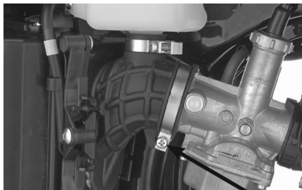
PARAFUSO DA BRAÇADEIRA PARAFUSO DE FIXAÇÃO
