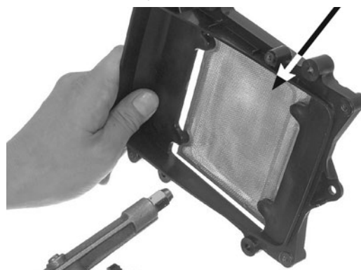
CARÇA DO FILTRO DE AR CARÇA DO FILTRO DE AR SECUNDÁRIO
